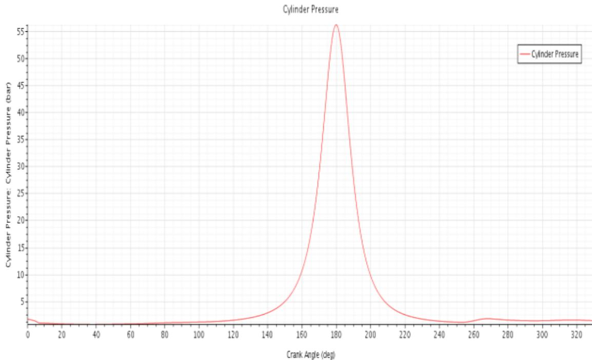
**Figure 16.** (d) Pressure vs Crank angle at 3000 rpm.
