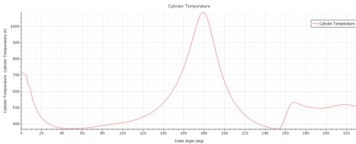
**Figure 17.** (d) Temperature vs Crank angle at 3000 rpm.
