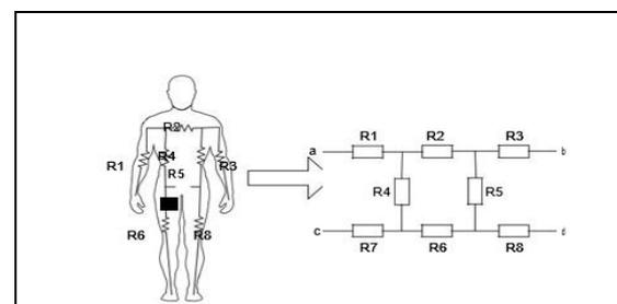
Fig. 1. Eight-Segment Impedance Model.
