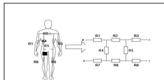
Fig. 1. Eight-Segment Impedance Model.
